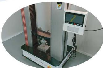
陶瓷罩钎焊拉拔力检查
